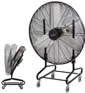
ナカトミが今夏発売した、エアモーター工場扇は引火のある場所、粉塵の多い場所での送風・換気、機械の冷却にバツグンの威力を発揮します。多くの工場で利用されている圧縮空気で駆動しますので、粉塵や油分、湿気のある場所でも使用が可能です。なお、エア－供給源は3馬力以上のコンプレッサが必要となります。使用に適した場所としては、ガソリンスタンド・造船所・化学工場・塗装工場・処理場などがオススメです。それ以外の場所でも、エア－配管設備がある場所なら、エアホースを接続すればすぐに使用できます。
