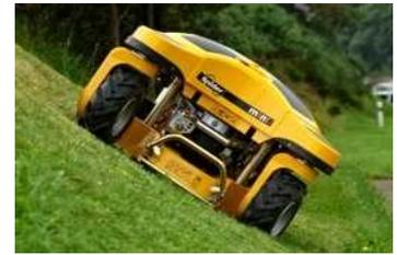
軽量アルミニウム合金、低重心の安定構造で、最大傾斜角は30～55°まで対応し、傾斜地の草刈にバツグンの高性能！もちろん上位機種はILD01とILD02の取扱もございます。ILD01なら除雪にも対応でき、大変便利です。
